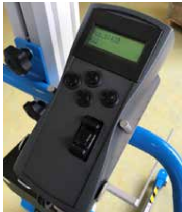
PosiSet bis zu 12 frei speicherbare und mm-genau anfahr- bare Hubhöhen (mit Höhenanzeige im Display)
