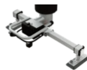
Traverse mit 2 Sauggreifern 500, 800, 1200 ↑ 2x 120x210, 120x315, 200x290
