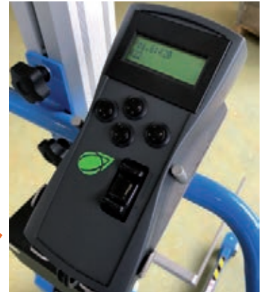
PosiSet bis zu 12 frei speicherbare und mm- genau anfahrbare Hubhöhen (mit Höhenanzeige im Display)
